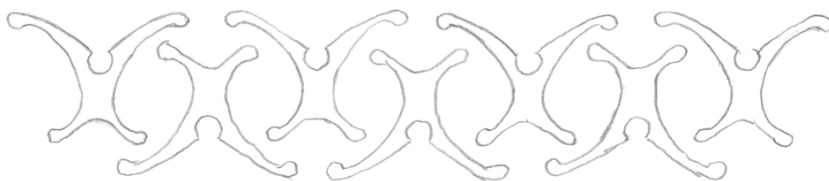
Az X-CYCLONE® elválasztó prototípusa repülőgép-szárny alakú X-profilokkal
