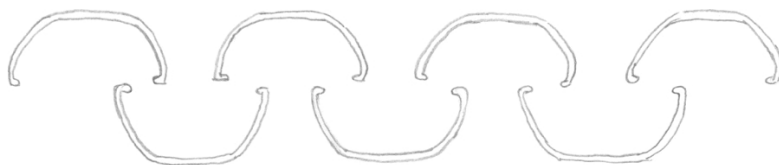
Separatoare cu plăci de impact cu profile în formă de U
