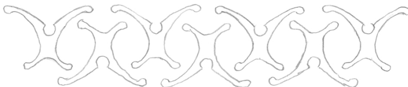
Prototip al separatorului X-CYCLONE® cu profile X în formă de aripi de avion
