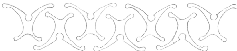
Prototype van de X-CYCLONE®-afscheider met X-profielen in de vorm van vliegtuigvleugels
