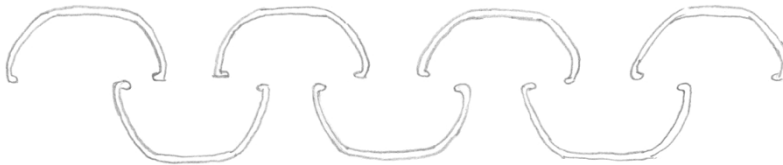
Prallblech-Abscheider mit Profilen in U-Form
