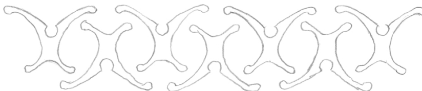
Prototipo dello separatore X-CYCLONE® con profili a X a forma di ali di aereo
