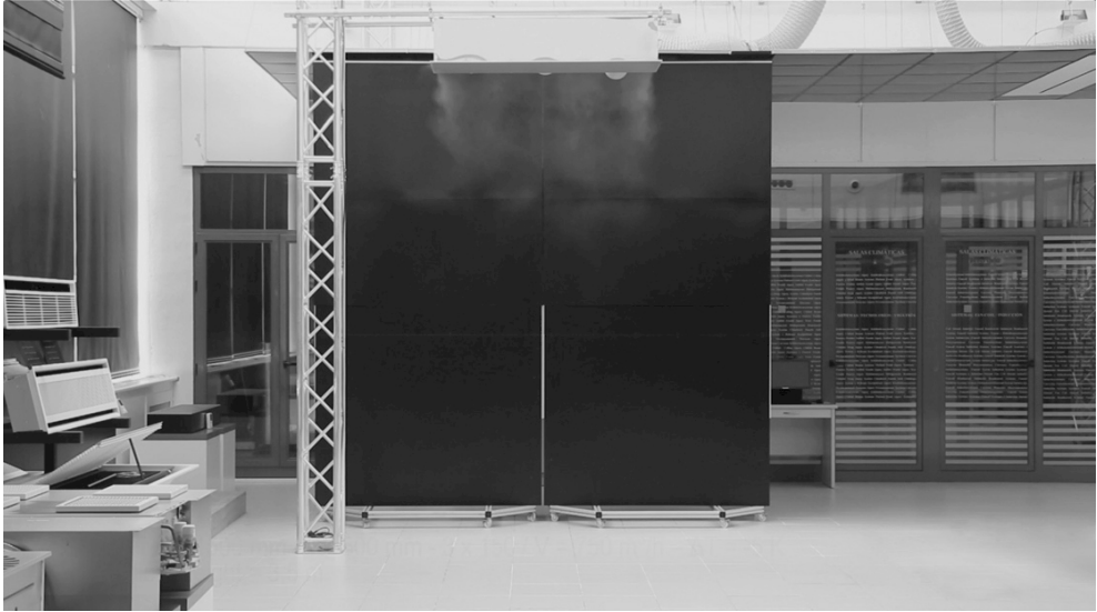
Aperçu du dispositif d'essai pour la visualisation des écoulements d'air d'alimentation
