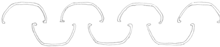
Separadores de chapa de impacto con perfiles en forma de U
