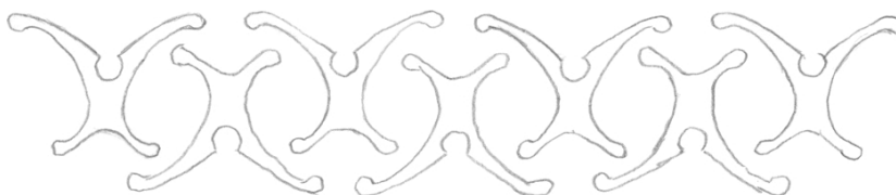
Protótipo do separador X-CYCLONE® com perfis em X no formato de asas de avião
