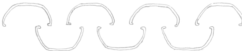
Separadores com chapas defletoras com perfis em forma de U
