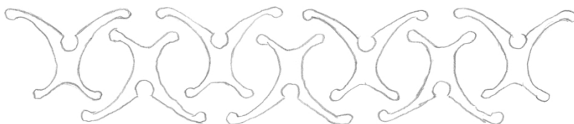
X-CYCLONE® 分离器原型 采用飞机机翼形状的X型型材
