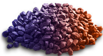
Abb.: EGN 99-Granulat, mit Kaliumpermanganat links neu und rechts gesättigt
