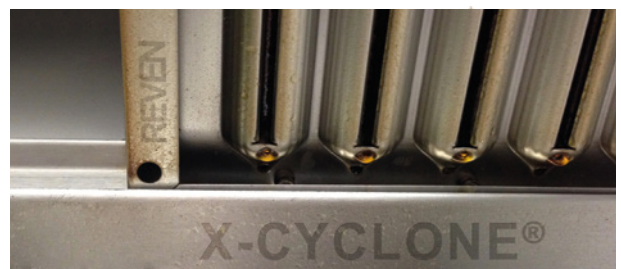
Ausschnitt eines X-CYCLONE® Abscheiders. Die abgeschiedenen Ölpartikel bilden Tropfen und laufen ab.
