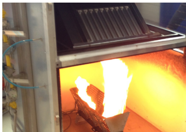
Prüfstand zur Flammendurchschlagsicherheit der Abscheider
