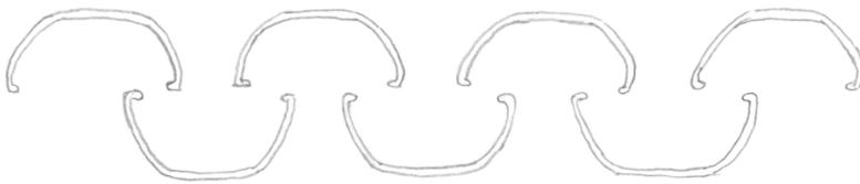
带U型型材的挡板分离器
