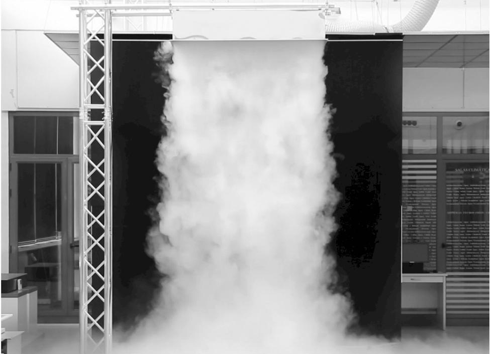
在 SCHAKO 实验室中，通过雾化机使送风可见。可以看到，送入的空气轻轻地向下流动。
