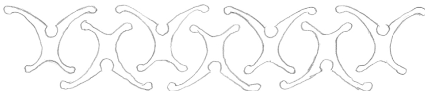
Прототип сепаратора X-CYCLONE® з X-профілями у формі крила літака
