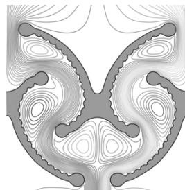
Analiza CFD o przepływu cząstek o różnych rozmiarach
