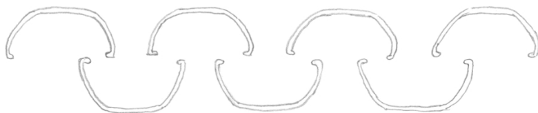
Separatorzy z płytą udarową z profilami w kształcie litery U
