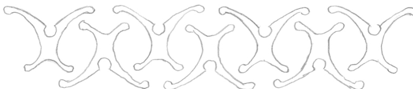
Prototype af X-CYCLONE®-separatoren med X-profiler i form af flyvinger
