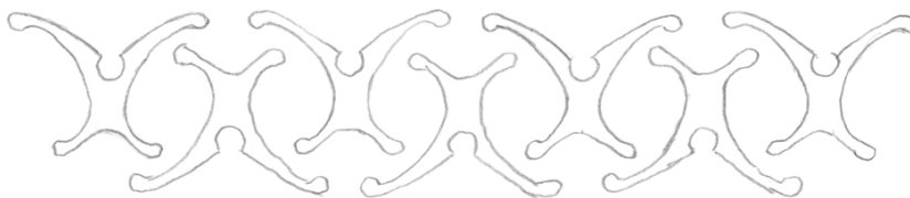
Prototipo del separatore X-CYCLONE® con profili a X a forma di ali di aereo
