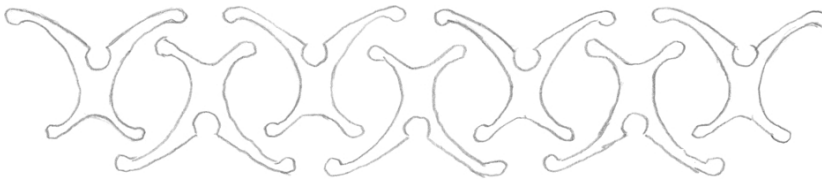
Prototipo del separador X-CYCLONE® con perfiles en X con forma de alas de avión
