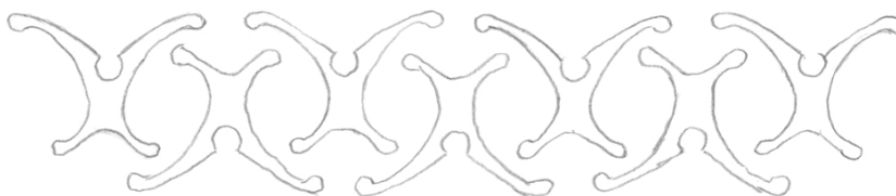
Protótipo do separador X-CYCLONE® com perfis em X em forma de asas de avião
