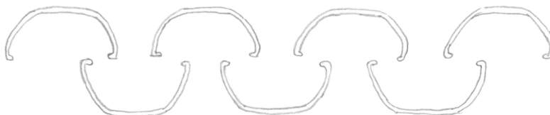
Separadores de chapa defletora com perfis em forma de U
