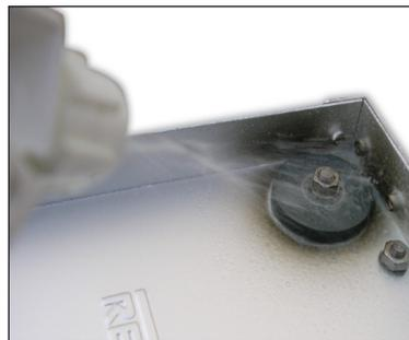
Alle Verschmutzungen sind mit einem geeigneten Fettlöser einzusprühen.\*
