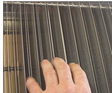
Vor Einsetzen sind die Ionisationsdrähte auf Vollständigkeit zu überprüfen.\*
