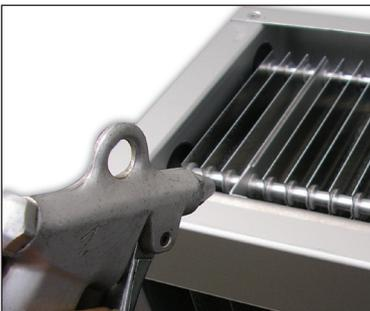
Nach dem Reinigen und Abspülen des Kollektors wird dieser mit Pressluft getrocknet.
