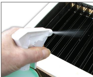
Zur Reinigung der Kollektorplatten und den Ionisationsdrähten verfahren Sie gleich.
