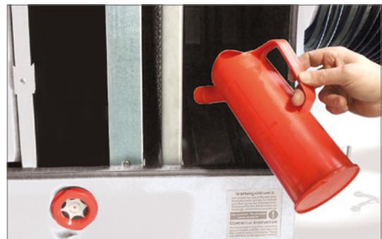
*Werden Siphon oder Schlauch nicht wie beschrieben mit Flüssigkeit gefüllt, steigt der Flüssigkeitsspiegel am Boden des Gehäuses in unzulässiger Weise an, was eine negative Auswirkung auf die Abscheideleistung sowie auf die Hochspannungsversorgung der Kollektoren hat.*
