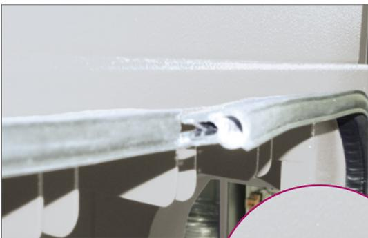
Abb.: Alte Dichtung entfernen
