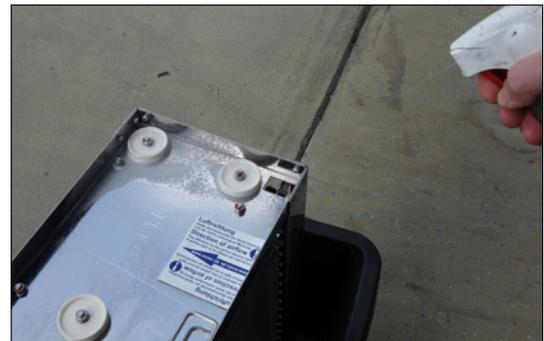
Alle Verschmutzungen mit einem geeigneten Fettlöser einsprühen. Empfohlen wird der biologische Entöler „Oil-Free V2000“.
