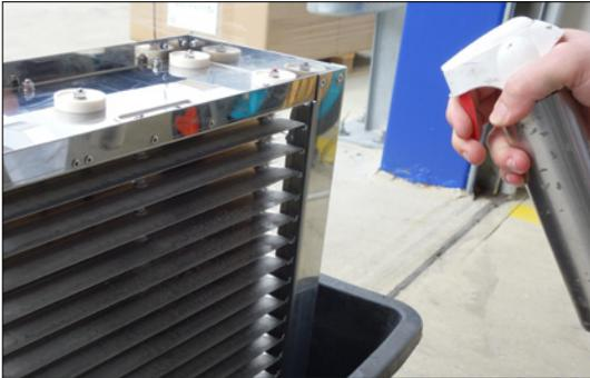
Zur Reinigung der Kollektorplatten und Ionisationsdrähte in gleicher Weise verfahren.
