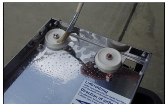
Nach etwa 10 Minuten Einwirkzeit Verschmutzungen mit einem Pinsel entfernen.
