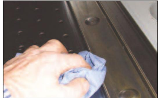
Vor dem Einsetzen der Kollektoren die Filterböden reinigen.
