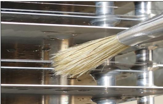
Auch diese lassen sich nach 10 Min. Einwirkzeit gut mit einem weichen Pinsel reinigen.
