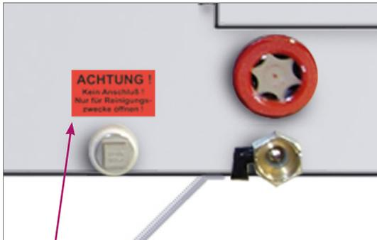
Die linke Muffe *nur für die Reinigung* der Ventilator-kammer öffnen und danach wieder schließen (siehe Seite 29).
