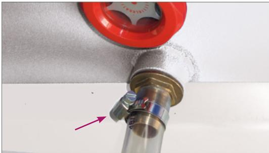
Schlauchanschluss für Flüssigkeitsschlauch,
