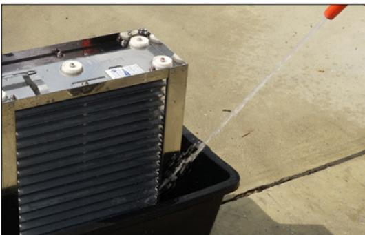
Nach dem Reinigen den Kollektor gut mit klarem Wasser (*max. 30 °C*) abspülen.
