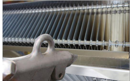
Anschließend den Kollektor mit Pressluft trocknen.
