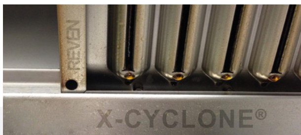
Ausschnitt eines X-CYCLONE® Abscheiders. Die abgeschiedenen Ölpartikel bilden Tropfen und laufen ab.
