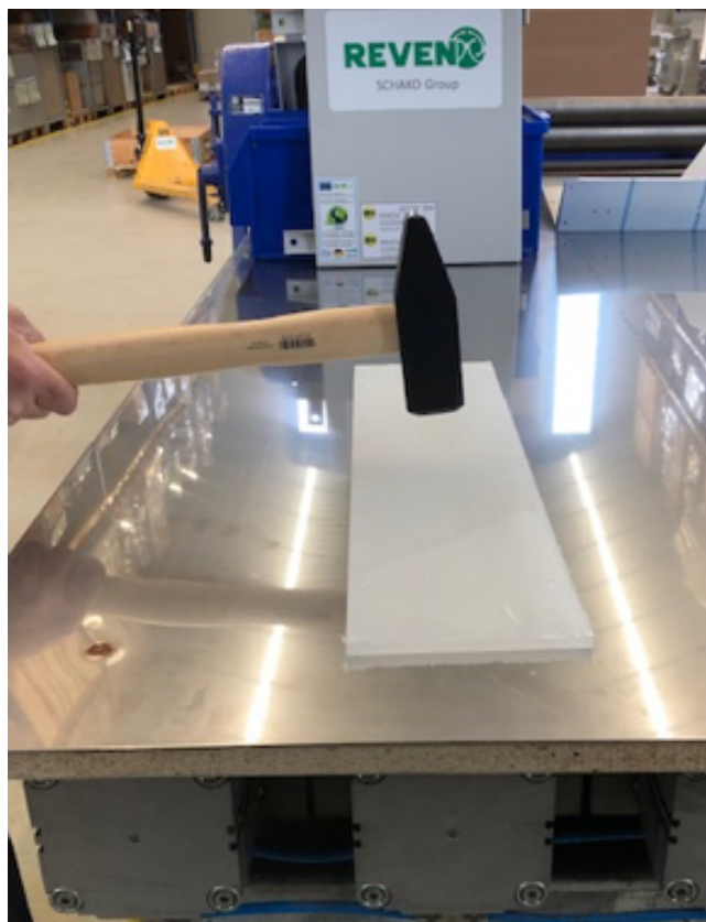
Abb.: Test der Bruchfestigkeit mit einem 5 kg schweren Hammer am schwächsten Teil des Gehäuses, der PLEXIGLAS® Abdeckung.
