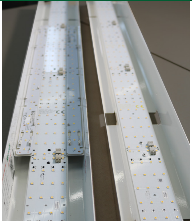
Abb.: Der Innenspiegel hat genügend Platz für schmale Platinen, die für die Notbeleuchtung sorgen.
