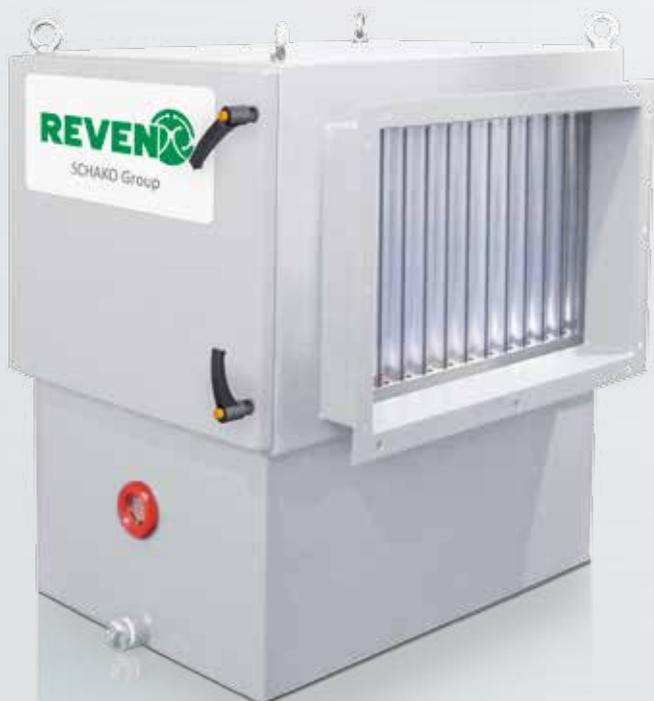
Das X-CYCLONE® Grundelement ist komplett wartungsfrei und selbstreinigend! Die im Grundelement abgeschiedenen Aerosole laufen als Fluidmasse von oben nach unten entlang der X-CYCLONE® Profile ab. Die ablaufende Flüssigkeit schwemmt auch angelagerte Feststoffe ab und wäscht sie aus den Profilen des Grundelements aus.
