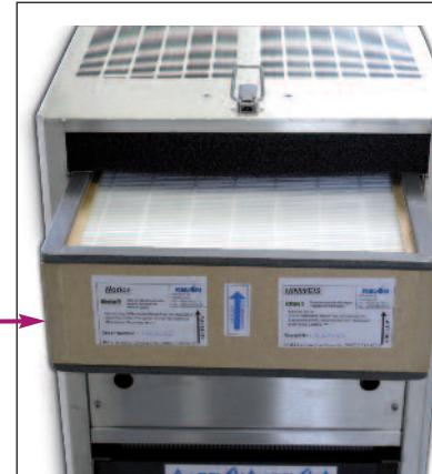
Der HEPA H13 Hochleistungspartikel- und Feinstaubfilter ist ein Wegwerffilter und muss ungefähr alle 12 Monate ausgetauscht werden. Wurde dieser Filter beim Absaugen von → gesundheitsgefährdenden Stoffen eingesetzt, muss er als → Sondermüll entsorgt werden.
