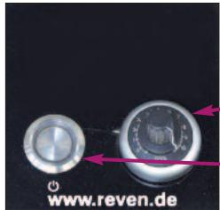
Potenziometer zur stufenlosen Einstellung der Luftmenge
